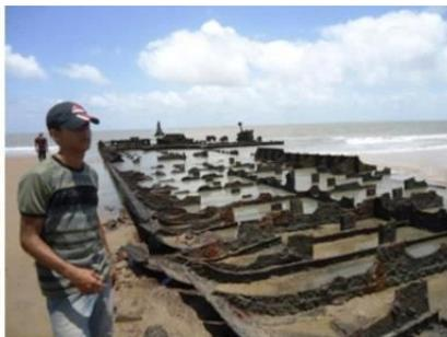
Navio encalhado propositalmente na praia recoberto por sedimentos e em acelerado estado de corrosão
