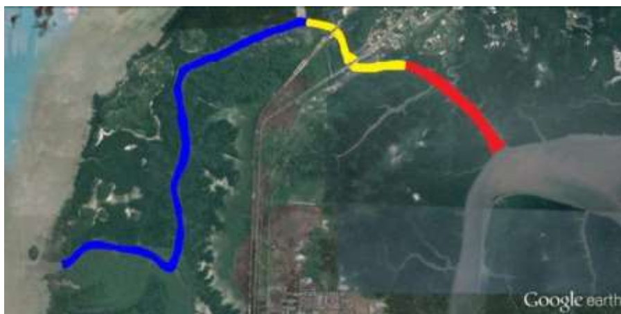
Figura 06: Mapa síntese dos processos morfológicos identificados no Estreito dos Mosquitos entre maio de 2011 e 2012. (Azul=deposição, Amarelo = equilíbrio, Vermelho = erosão).
