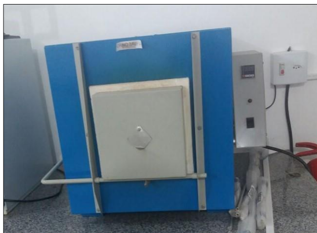
Figura 13- Forno mufla usado para a análise de matéria orgânica pelo método direto
