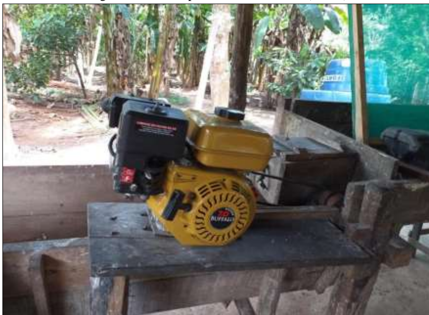
Figura 30 – Motor para triturar mandioca (caititu)
