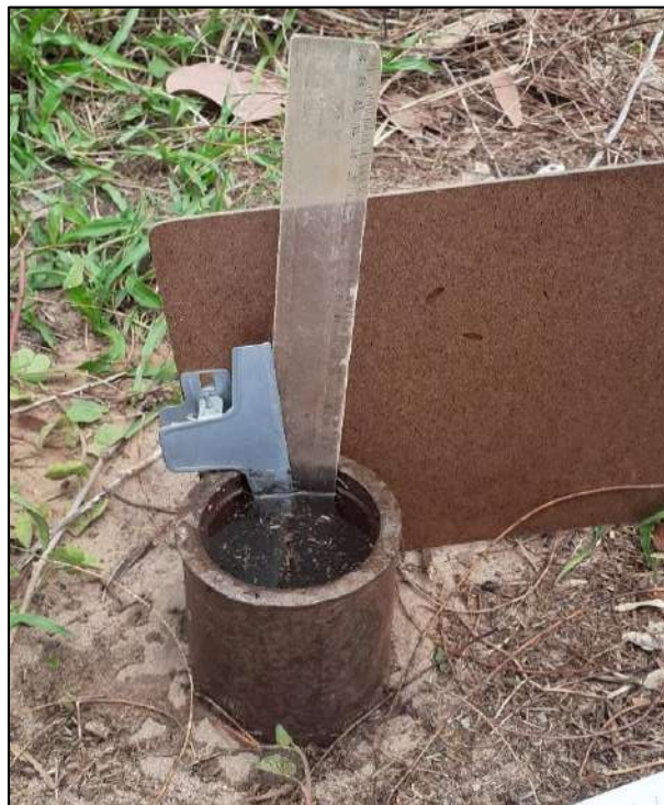
Figura 19 - Régua usada na medição de infiltração.
