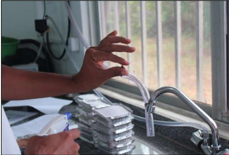
Figura 23 - Verificação da pegajosidade da amostra.
