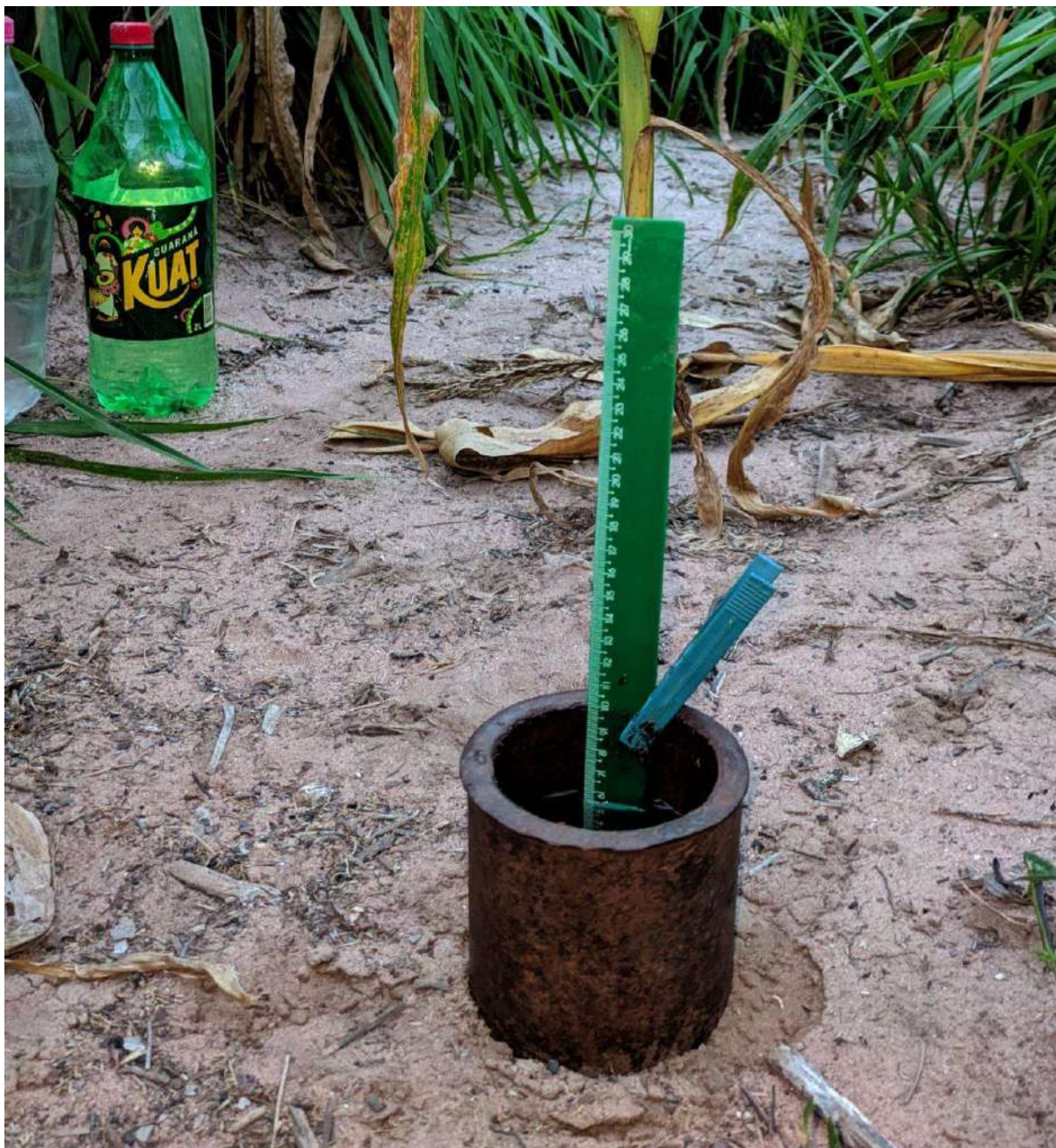
Figura 5: Infiltrômetro devidamente fixado com a régua e prendedor para o teste.
